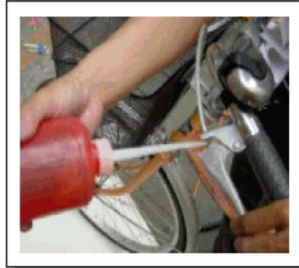
左圖：剎車線須有一點緊度，如有分叉，代表有斷裂之虞，宜盡快更換
